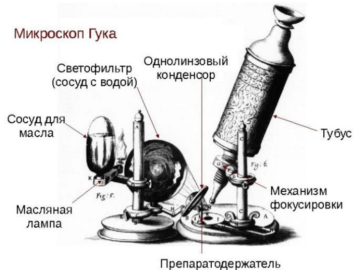
Помимо объектива и окуляра микроскоп имел 2 дополнительные линзы и диафрагму
