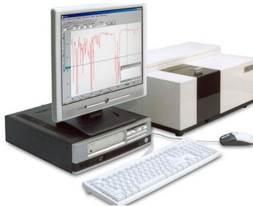
Рисунок 1.7 Измерительная установка на основе фурье-спектрометра
