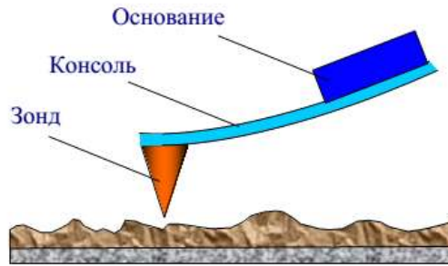
Рисунок 2. Схематическое изображение зондового датчика АСМ [28].
