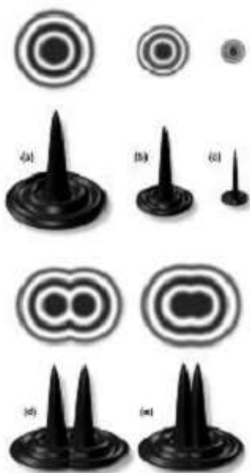
Рисунок 7. На рисунке показаны зависимости размеров дисков Эйри и относительной интенсивности дифракционных изображений от числовой апертуры объективов. От (а) к (с) числовая апертура растёт; (d) – интенсивности двух дифракционных изображений находятся на пределе разрешения; (e) – интенсивности двух дифракционных изображений перекрываются [32].
