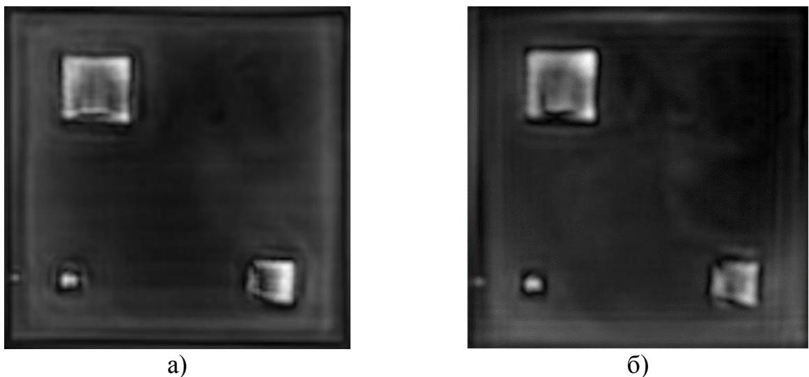
Рис. 67. Восстановленные комплексным алгоритмом обработки радиоизображения образца ТИП с квадратными дефектами:
