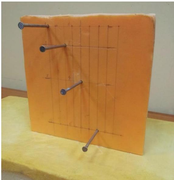
Рис. 29. Тестовый объект для экспериментальной оценки продольного разрешения разработанного радиолокатора
