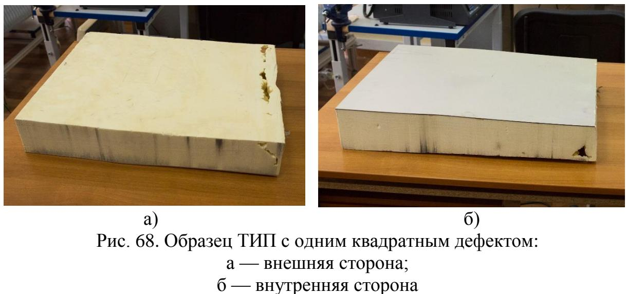
Рис. 68. Образец ТИП с одним квадратным дефектом:
