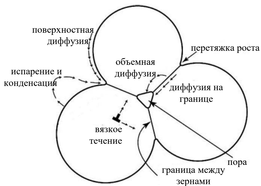
Рис. 2.3. Объединение трех сферических частиц под действием разных видов диффузии.
