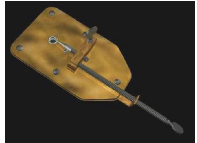
Микроскоп Левенгука XVII века с увеличением до 300х
