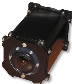
Рис. 12. Внешний вид созданного УФ сенсора.
